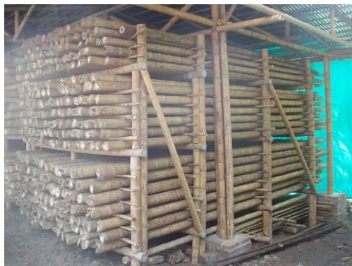
Figura 07 – Secagem do bambu em local coberto.
