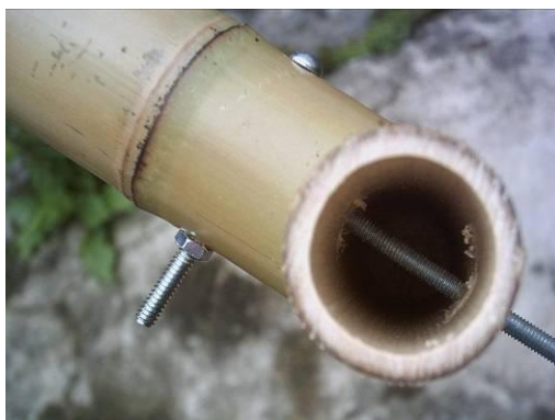
Figura 31 – Exemplo de conexão com barra roscada.
