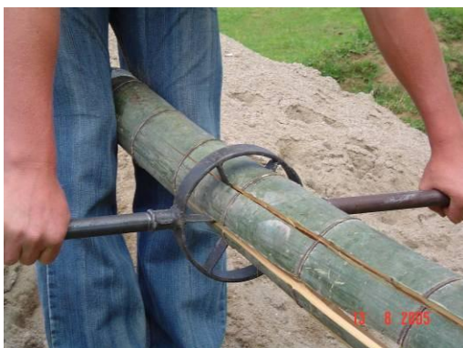
Figura 38 – Utilização de faca radial para confecção de ripas.
