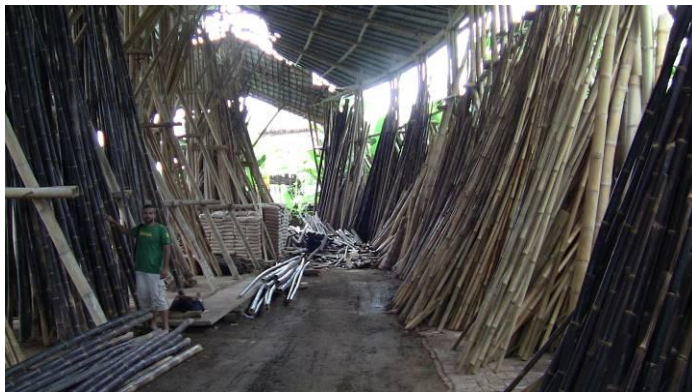
Figura 08 – Secagem do bambu em local coberto, na vertical.
