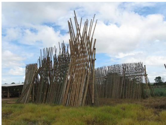
Figura 09 – Secagem do bambu em local descoberto, na vertical.
