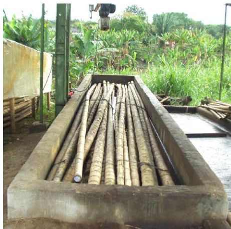
Figura 12 – Tanque em concreto para imersão
