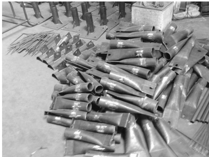
Figura 13: Uniões metálicas após fabricação
